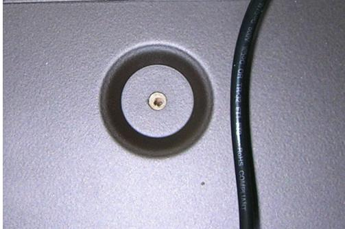
Figure 3 — Vis de fixation supérieure
